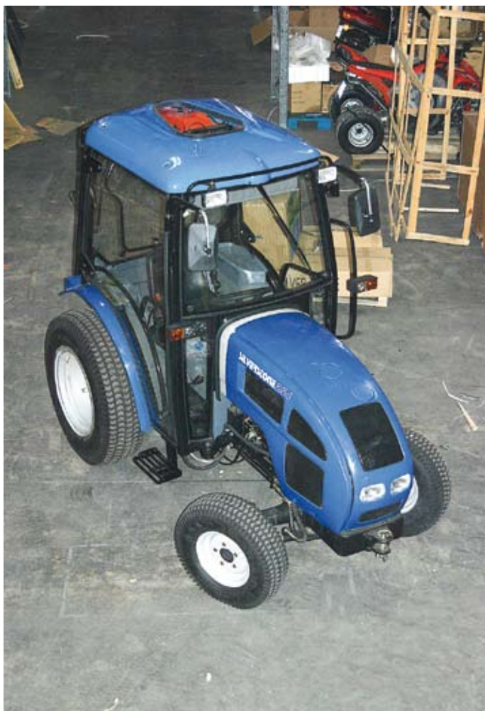
Hytten till den kinesiska traktorn är tillverkad i Polen. Stora glasade rutor ger bra runtomskikt från förarplats.
